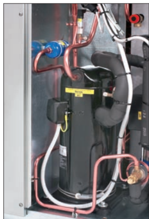
Compressoare rotative sau scroll, în funcție de model
